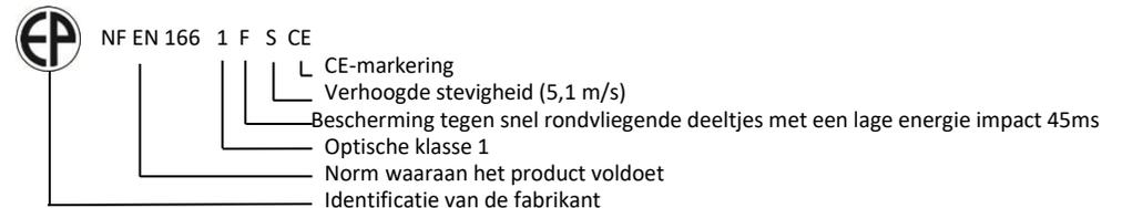
**RESERVEONDERDELEN, ACCESSOIRE EN MONTAGE INSTRUCTIE :** Gebruik uitsluitend originele reserveonderdelen. Controleer, bij het vervangen van de lasruit, de compatibiliteit van de markering. De helm moet worden gebruikt met een filter voor het lassen.
