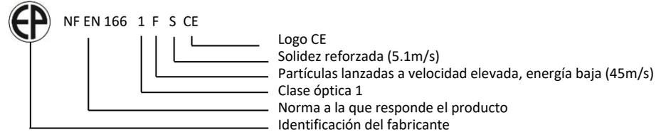
**PIEZAS DE RECAMBIO, ACCESORIOS E INSTRUCCIONES DE MONTAJE :** Utilice solo piezas de recambio originales. Para sustituir el vidrio, asegúrese de la compatibilidad del marcado. El casco debe ser utilizado con un filtro para la soldadura.
