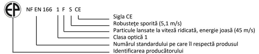
**PIESE DE SCHIMB, ACCESORII ȘI INSTRUCȚIUNI DE ASAMBLARE:** Folosiți doar piese de schimb originale. Pentru a înlocui sticla, trebuie să verificați marcajul de compatibilitate. Casca trebuie să fie utilizat cu un filtru pentru sudarea.
