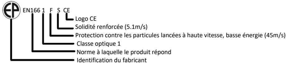
**PIECES DE RECHANGE, ACCESSOIRE ET INSTRUCTION DE MONTAGE :** Utilisez uniquement des pièces de rechange d'origine. Pour remplacer le verre, vous devez vous assurer de la compatibilité du marquage. Le casque doit être utilisé avec un filtre pour la soudure. Détail : voir document : « welding helmet assembly ».
