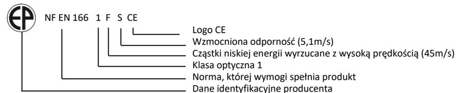
**WYMIANA CZĘŚCI, AKCESORIA I ZAKŁADANIE:** Stosować tylko oryginalne części zamienne. Przed wymianą szyby wizjera, należy sprawdzić zgodność oznakowania. Kask może być stosowany z filtrem do spawania.
