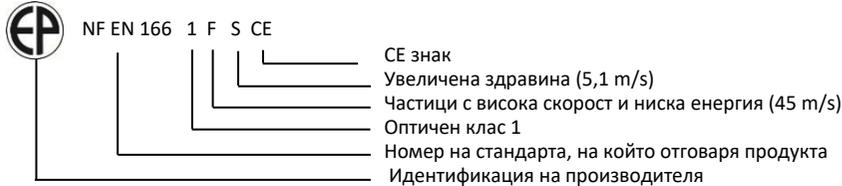
**РЕЗЕРВНИ ЧАСТИ, АКСЕСОАРИ И ИНСТРУКЦИИ ЗА МОНТАЖ:** Използвайте единствено оригинални резервни части. За да смените стъклото, вие трябва да проверите съвместимостта на маркировката. Каската трябва да се използва с филтър за заварка. Подробности: вижте документа “welding helmet assembly”.
